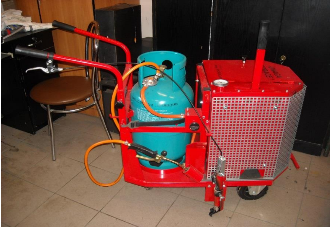
Zdj.59. Zalewarka szczelin i krawędzi typu HYDROG ZZSK-40
