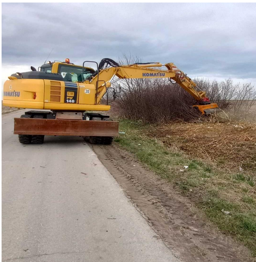
Zdj.62. Mulczer służący do usuwania drobnych gałęzi i krzewów
