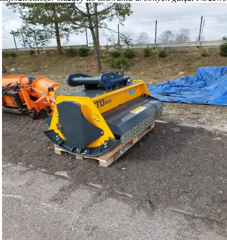
Zdj.63. Mulczer służący do usuwania drobnych gałęzi i krzewów
